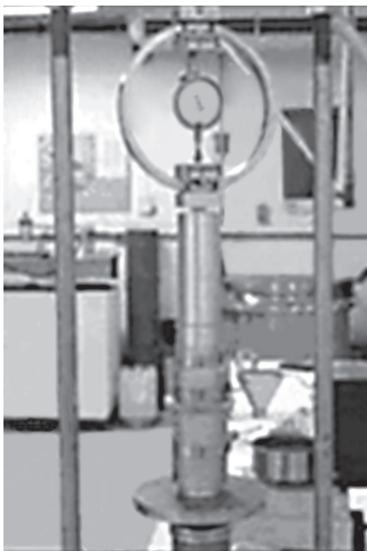
Figura 3 Equipamento utilizado na compactação semi-estática
